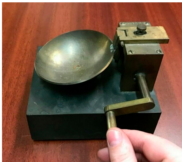
Рис. 3 Прибор Касагранде для определения предела текучести глинистых грунтов (пределы Аттерберга)
